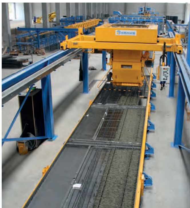
根据构件形状，安装完钢筋的托盘通过 Ebawe 自动混凝土布料机进行浇筑
