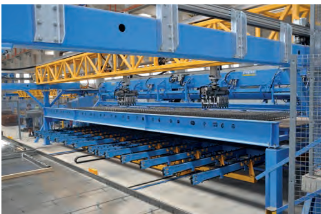
多轴机器人将库里的格构梁和纵向钢筋放置到位。矫直机生产纵向钢筋并将其放在链式仓库，下面的格构梁仓库将刚生产的格构梁运往托盘
