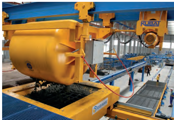
Kübat 吊斗轨道将混凝土输送到 Ebawe 混凝土布料机
