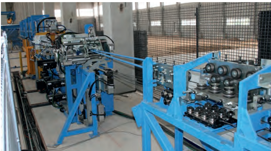
VGA Versa 格构梁焊接机从钢卷取材，准时生产不同高度的标准格构梁以及用弦杆和斜杆加固的定制格构梁
