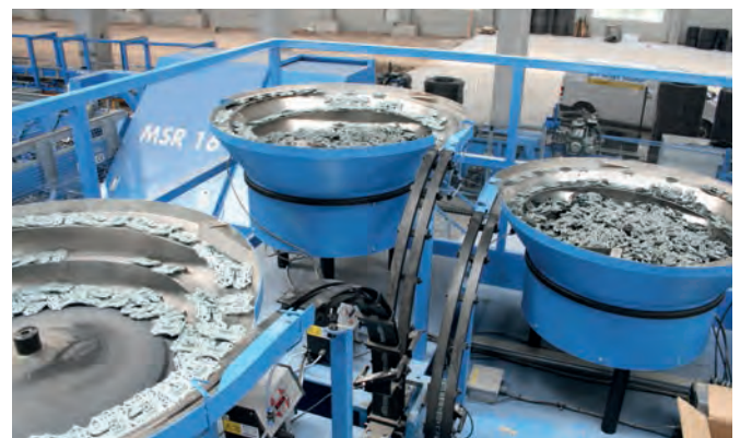
所需垫块分别从三个分拣罐取出并供给钢筋机械，然后压到纵向钢筋上
