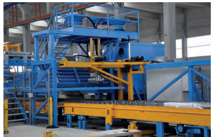
Progress 公司提供了一个特殊的钢筋解决方案：该工位包括两台生产纵横向钢筋的矫直机，自动垫块供给，以及两个用于精确放置钢筋和格构梁的机器人
