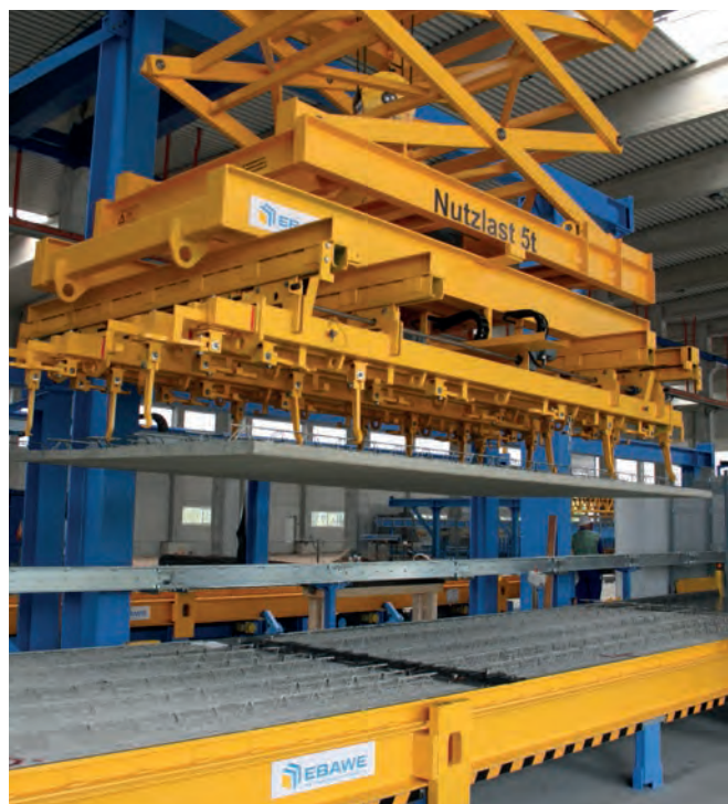
使用专用起重机直接将格构梁板与托盘分离
