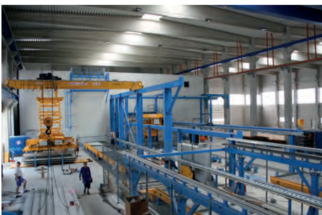
拆模区及后面的干燥室。混凝土浇筑站与拆模区平行，模板托盘从那里传送到干燥室
