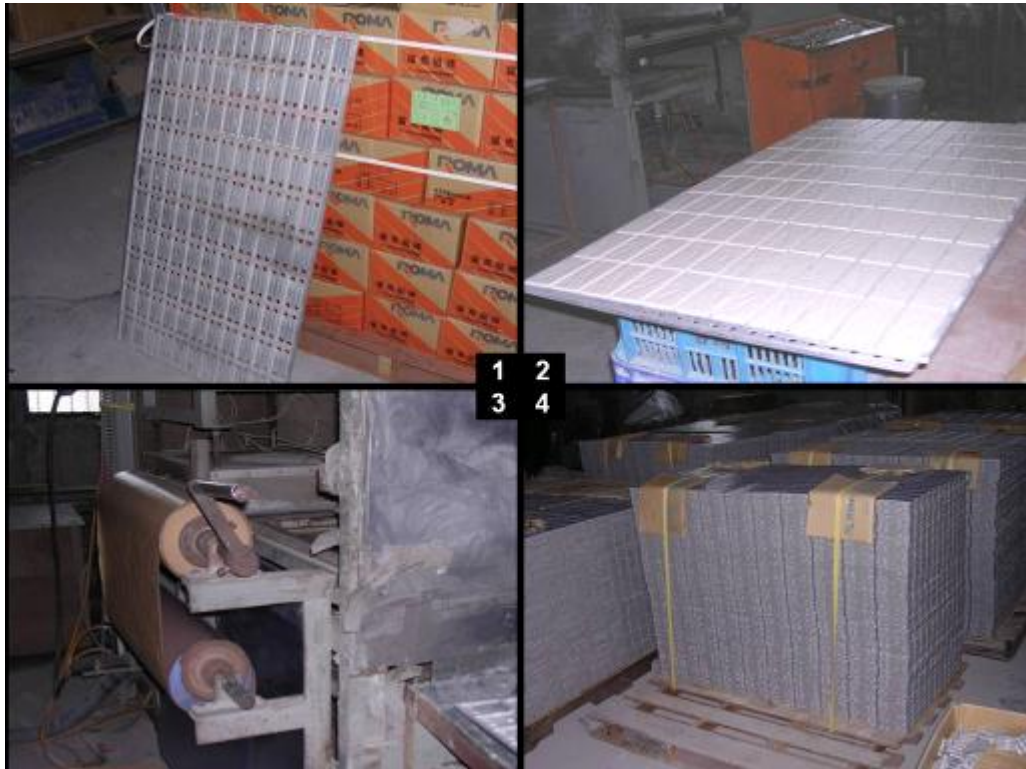
图 10. (1) 钢制版模，(2) 排砖入模，(3) 真空胶膜机，(4) PE 胶膜瓷砖成品
