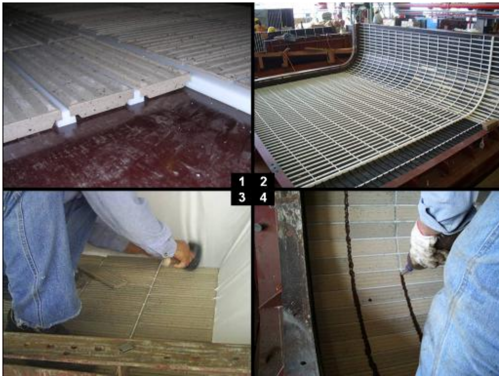
图 12. (1) 格子条与瓷砖, (2) 格子条固定模上情形, (3) 砖排入格子中, (4) 砖缝填上填缝剂
