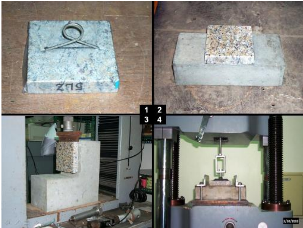
图 15. 石材爪钉性能试验
