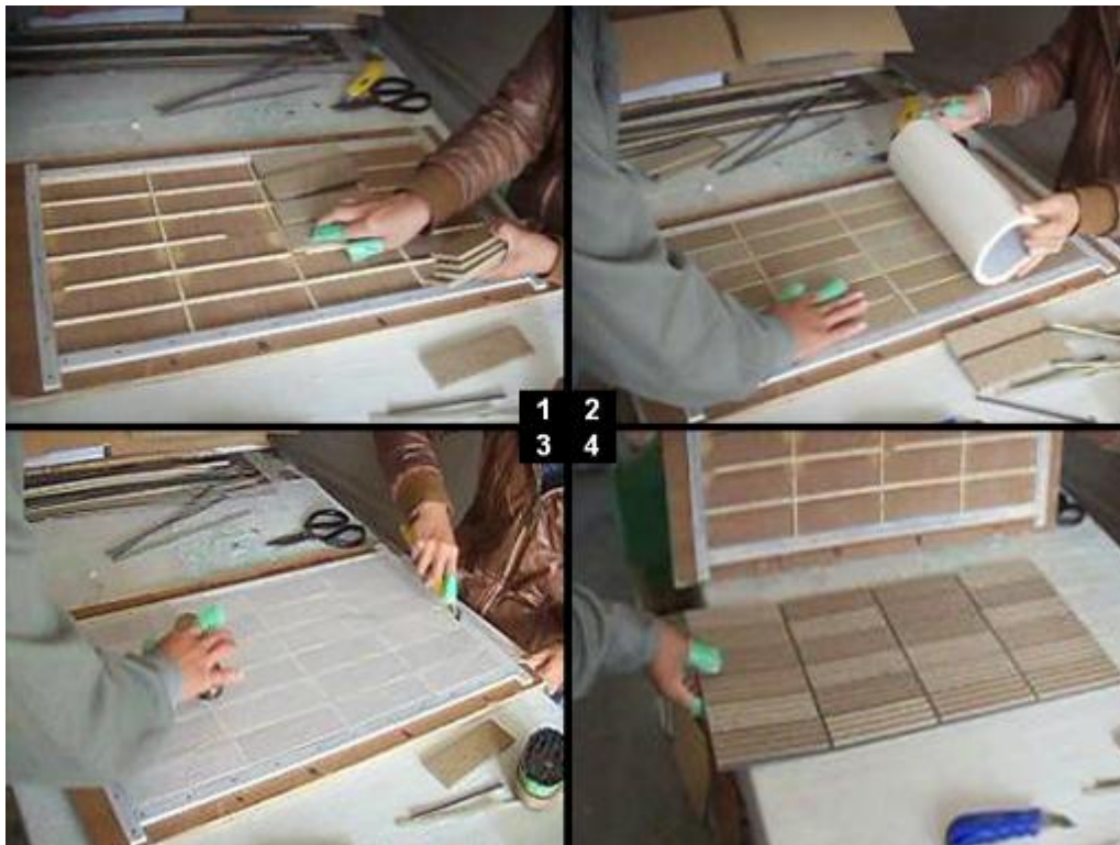
图 9. (1) 瓷砖版模，(2) 贴胶膜，(3) 压实，(4) 反转成型
