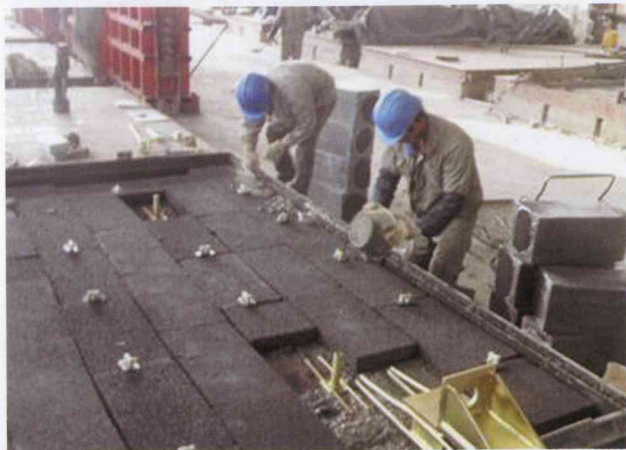
图 17 上海预制装配式建筑研发中心城建海港基地2号试点楼夹芯保温预制外墙板生产
