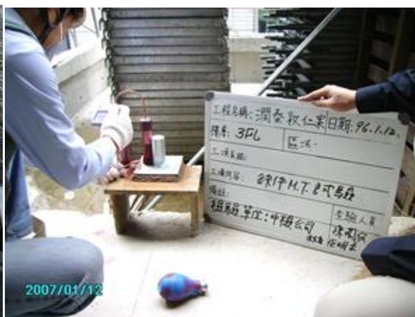
图 22 磁粉探伤 MT 检测
