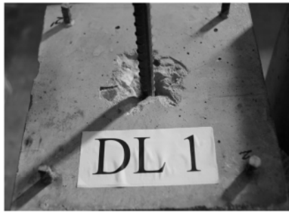
图6 连接筋根部锥形破坏
