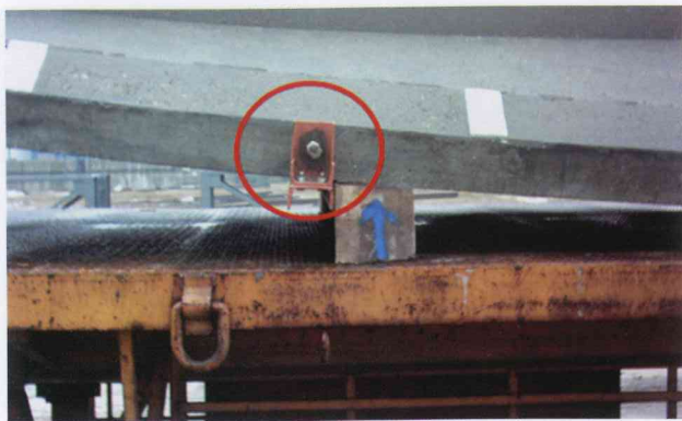
图 32 预应力造型板辅以抗裂拉杆运输情形
