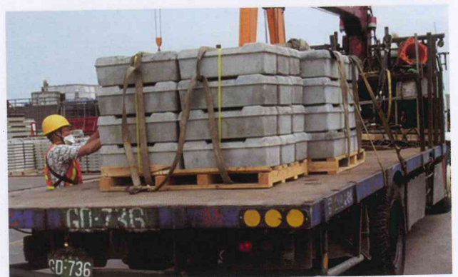
图7 随车起重货车及其装货情形
