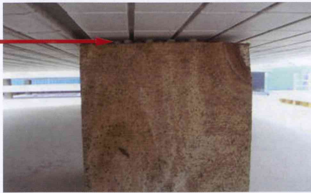
图 28 枕木上置塑料垫片防污情形
