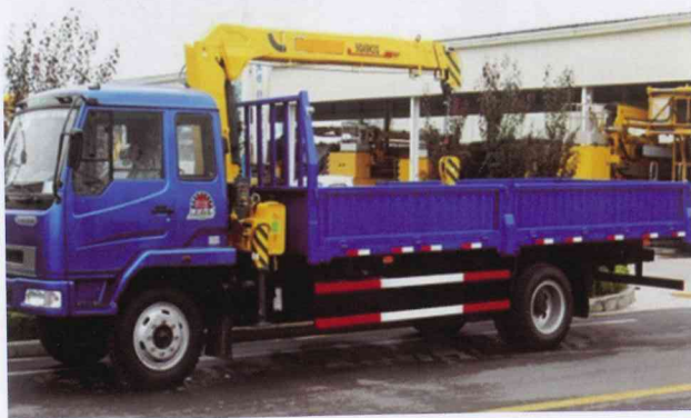
图7 随车起重货车及其装货情形
