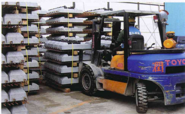
图8 高铁轨枕制品搬运情形
