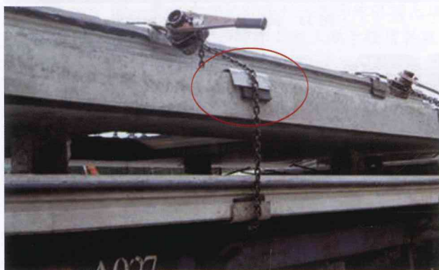
图 27 构件束紧部位加保护角铁情形
