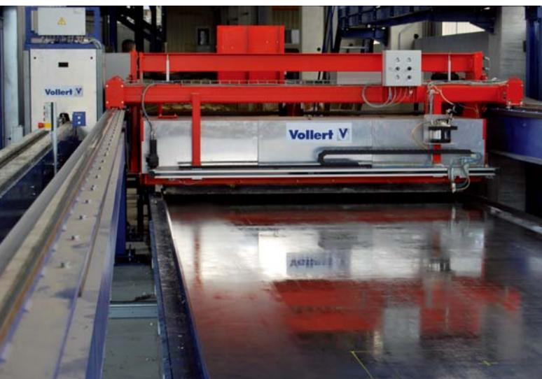
集清洁剂、脱模剂以及绘图仪于一体的机器
