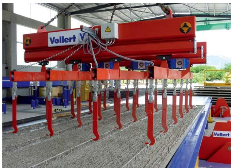
水平卸载预制空心楼板的卸载伸臂梁
