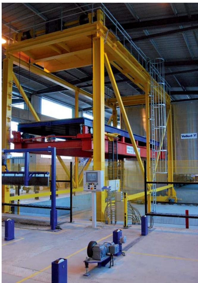
硬化室的货架操作设备用于托盘的存放和取出
