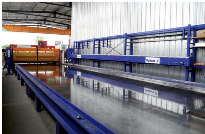
用于存储安放模具和构件的带模具运输设备的工位系统
