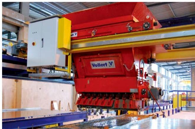
混凝土浇注的同时，通过低频振动站进行压实
