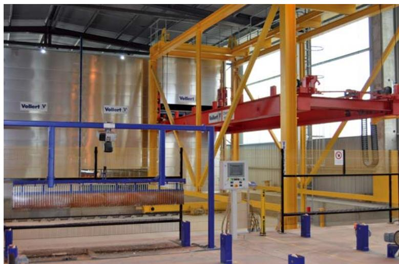
硬化室有三个货架塔，每个货架塔均有 10 个托盘存放架
