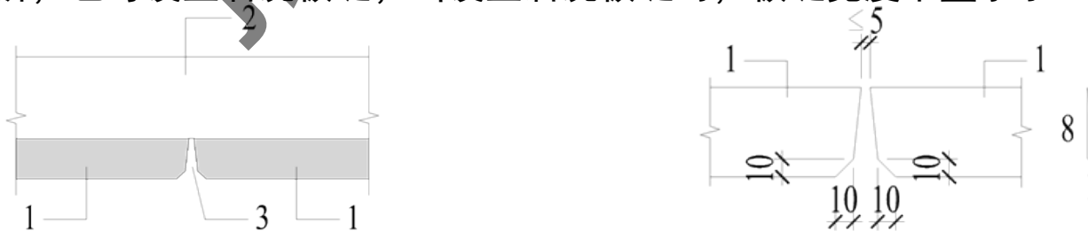
1—预制底板；2—后浇混凝土叠合层；3—拼缝处倒角
