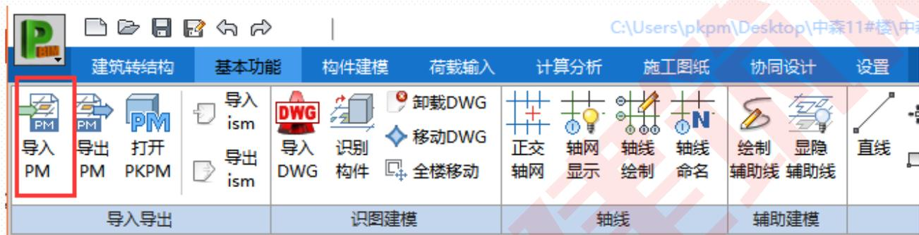
方法二：直接导入结构模型
